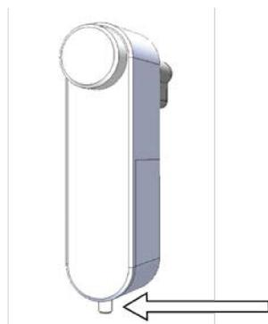
1. Lösen Sie die Design-Schraube.
